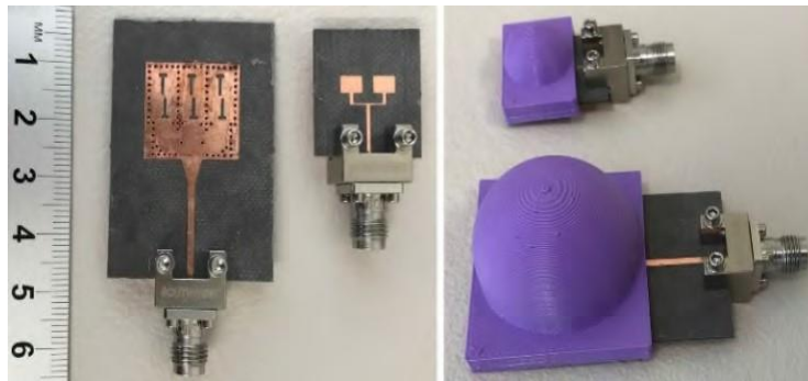
Şekil 9 - Önerilen dielektrik lens anten tasarımı (Malik vd., 2019:102471-102472).
