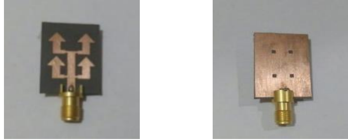
Şekil 17 - Önerilen anten ve DGS yapısı (Sandi vd., 2021: 3-4).
