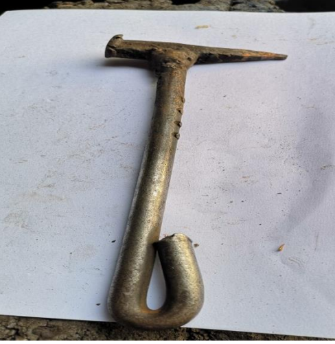
Foto 20: Demir sıcakken delik açmak için kullanılan zımba
