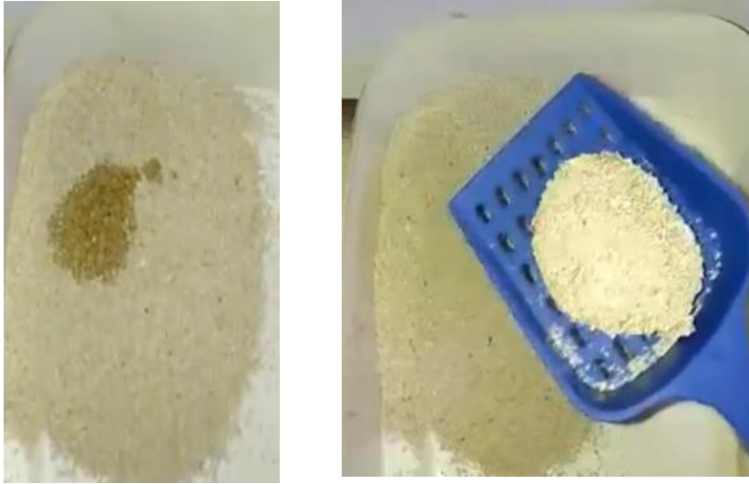
Şekil 3. Tepeköy Bentonit numunesinin saf su ile fiziksel değişimleri (1. Kuru hali, 2. İlk ıslatıldığında).
