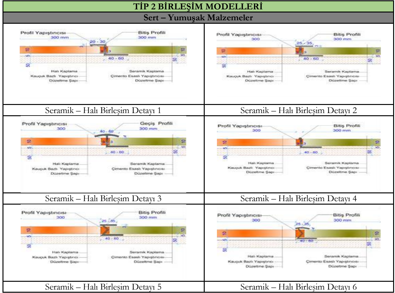
Şekil 22. Sert-Yumuşak Farklı Döşeme Kaplaması Geçiş Tip Önerileri
