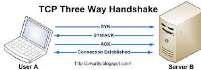
Şekil 23. 3-Way Handshake İletişimi
