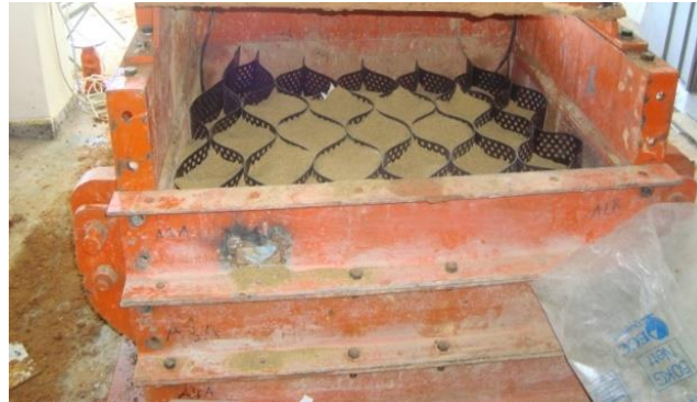
Şekil 1. Geocellin kum ile doldurulması
