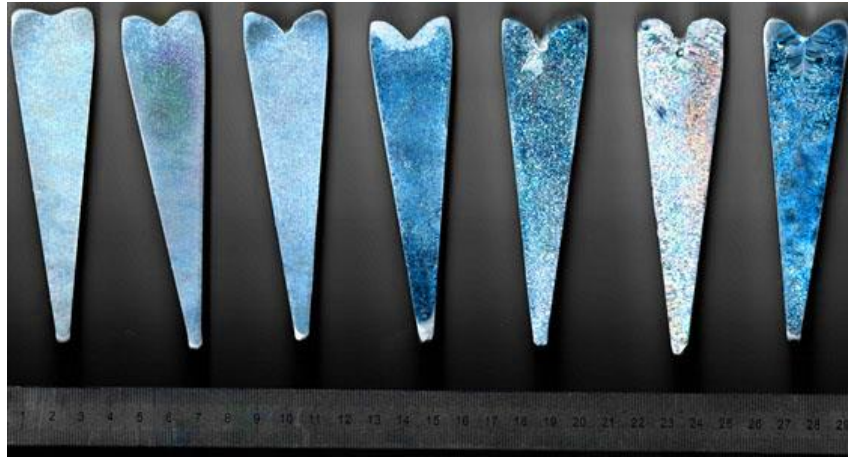
Şekil 14-Döküm numunelerin kesit görüntüleri
