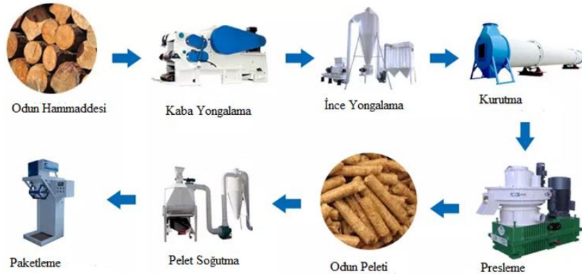
Şekil 4. Pelet üretim iş akışı (URL 4, 2022).
