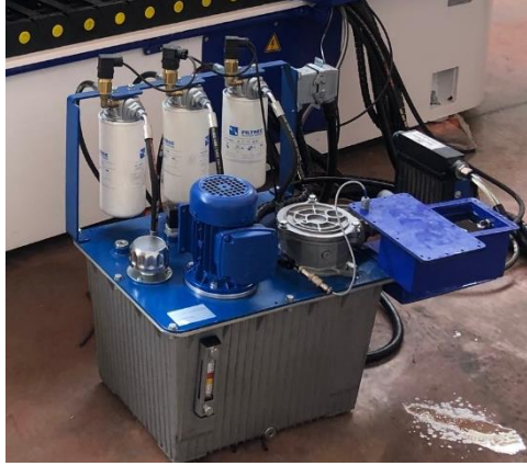
Şekil 4.1. Basınçlı yağlama sistemi
