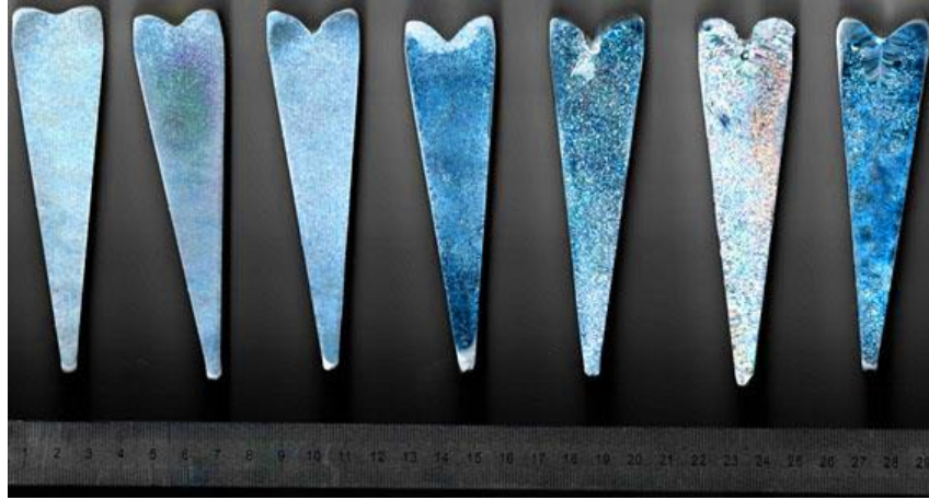
Şekil 22-Döküm numunelerin kesit görüntüleri
