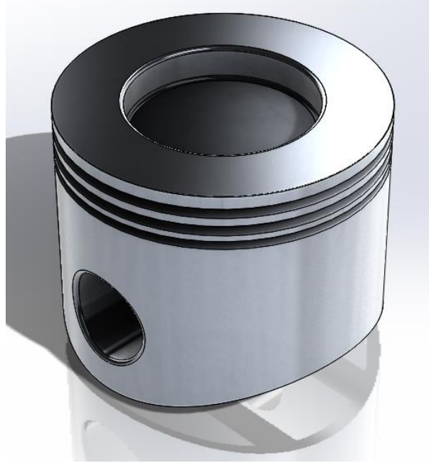
Şekil 15. Piston CAD Çizimi
