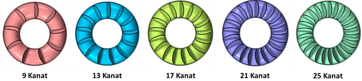
Şekil 6. Farklı kanat sayılarına sahip hidrolik kaplin tasarımları
