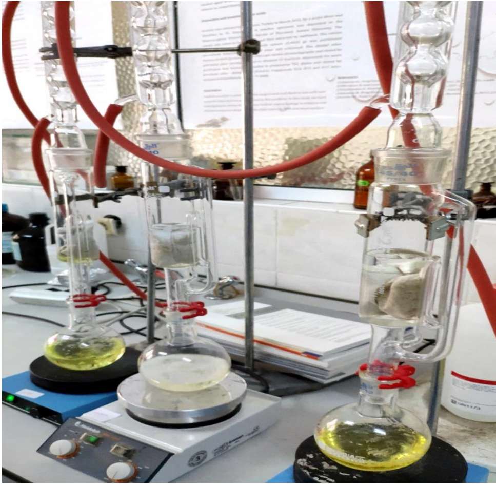
Şekil 2. Soxhlet aparatı ile susam tohumlarından sabit yağ eldesi
